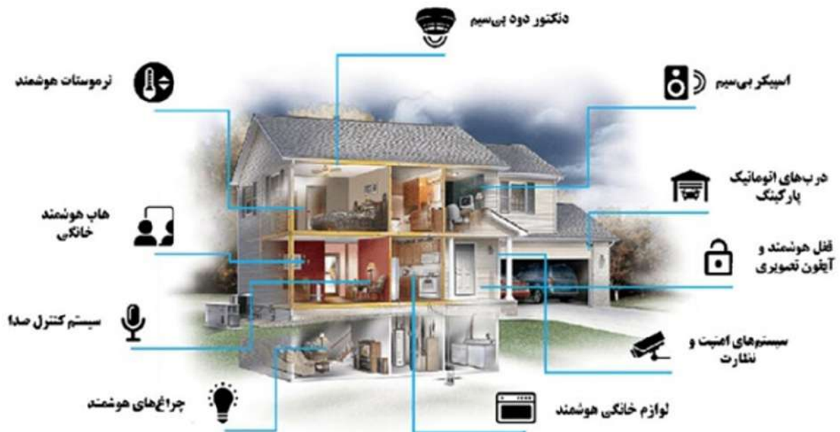
▲ شکل ۲- نمونه سیستم نظارت از راه دور ساختمان
