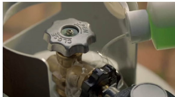
شکل ۴: تست نشتی اتصالات به شکل ایمن
