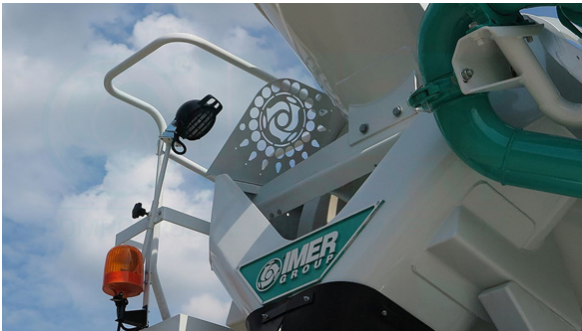
شکل ۹: نصب حفاظ در دهانه مخزن تراک میکسر
