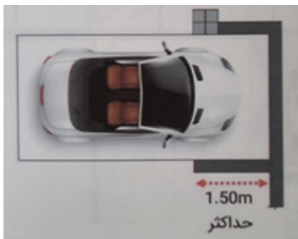
▲ تصویر ۴: نمایش حداکثر طول مانع برای اینکه به مانع تبدیل نشود.
