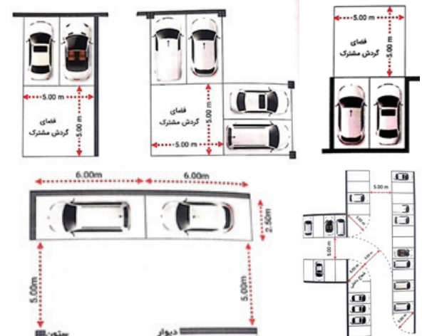
▲ تصویر ۱۰: نمایش حداقل شعاع گردش برای اتومبیل‌های سواری در حالت‌های مختلف
