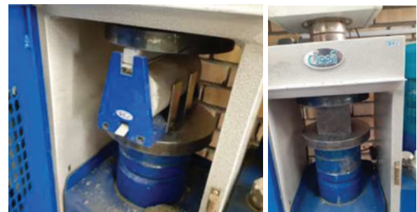
شکل ۴- آزمایش مقاومت کششی بتن به روش برزیلی
