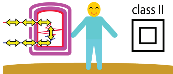
شکل ۵: تجهیزات برقی با دو لایه عایقی
