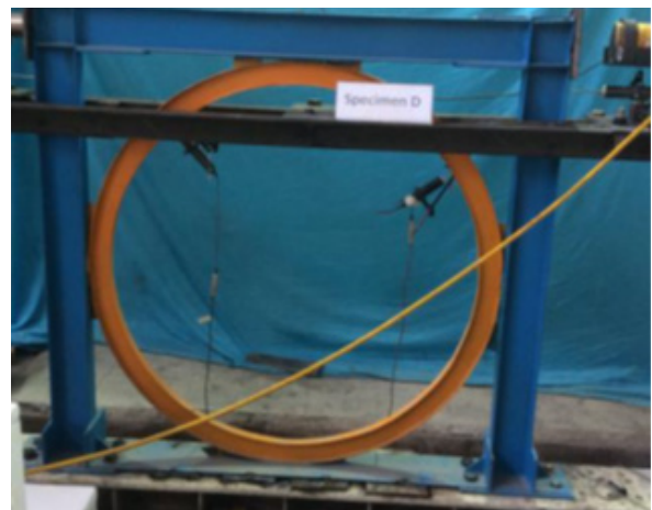
شکل ۹: نمونه آزمایشگاهی قاب مهاربندی با سیستم OGRID خم شده از بال [۳]
