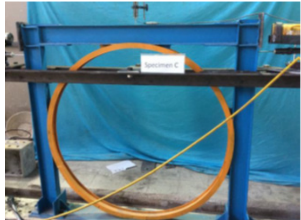
شکل ۸: نمونه آزمایشگاهی قاب مهاربندی با سیستم OGRID خم شده از جان [۳]
