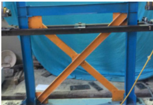
شکل ۷: نمونه آزمایشگاهی قاب مهاربندی [۳]
