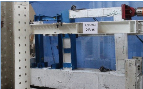
شکل ۳ تغییر شکل نهایی نمونه آزمایشگاهی قاب بتن‌آرمه تقویت‌شده با یک تیر پیوند با استفاده از سیستم (LCF) اثر اعمال نیروی ۳۳۳/۶ کیلو نیوتن با تغییر مکان نهایی ۲۷/۸ میلی‌متر (تغییر مکان نسبی ۴ درصد)
