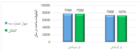
شکل ۳-۳ بار سرمایش و گرمایش سالیانه در حالت دیوار شماره ۳ و مصالح تجدیدپذیر
