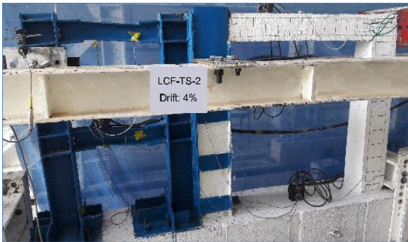
شکل ۴ تغییر شکل نهایی نمونه آزمایشگاهی قاب بتن‌آرمه تقویت‌شده با دو تیر پیوند با استفاده از سیستم (LCF) اثر اعمال نیروی ۳۳۳/۶ کیلو نیوتن با تغییر مکان نهایی ۲۷/۸ میلی‌متر (تغییر مکان نسبی ۴ درصد)
