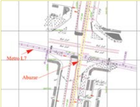
شکل ۱: پلان موقعیت محل تلاقی تونل انتقال آب ابوذر و تونل خط ۷ متروی تهران
