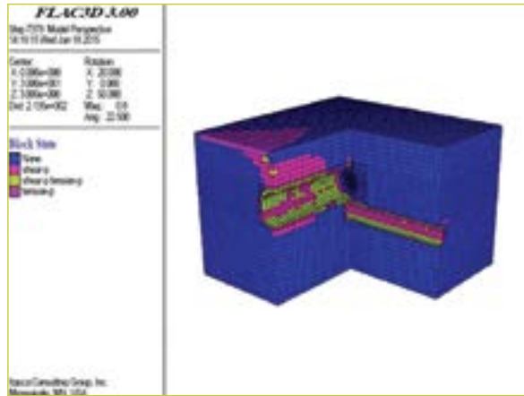
شکل ۸: گسترش زون پلاستیک در حالت قرار گیری کاترهد TBM بر روی تونل ابوذر
