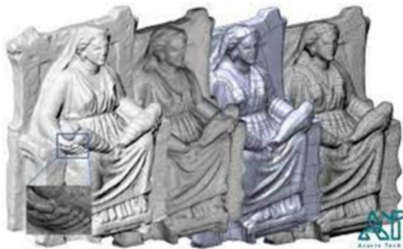
▲ شکل ۸. پایش تغییرات و فرسایش آثار تاریخی با بهره‌گیری از مدل‌های سه‌بعدی حاصل از فتوگرامتری
