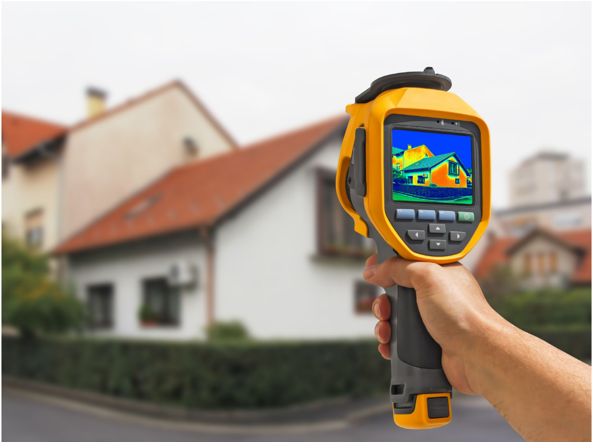
▲ تصویر ۲: دستگاه حرارت سنج یکی از ابزار موثر در ممیزی انرژی ساختمان‌ها
